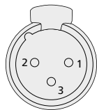
SALIDA DMX Conectores XLR (vista trasera)
